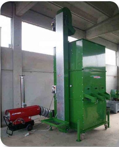
Séchoir de plateaux avec élévateur vertical
